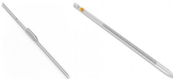
Рис. 2. Внешний вид мерной пипетки с одной меткой – пипетки Мора (слева) и градуированной мерной пипетки (справа).
