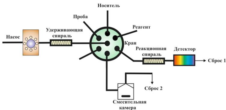
Рис. 29. Схема SIA MC.
