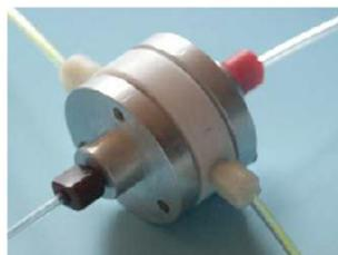
Рис. 63. Схема хроматомембранного массообменного процесса (а) и внешний вид хроматомембранной ячейки (б).
