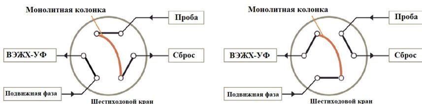
Рис. 60. Общая схема автоматизированной проточной твердофазной микроэкстракции: стадии сорбции (А) и десорбции (Б).
